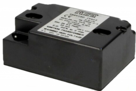
Transformateur électronique, 26KV, 30mA, primaire 230/240V, 50/60Hz,
